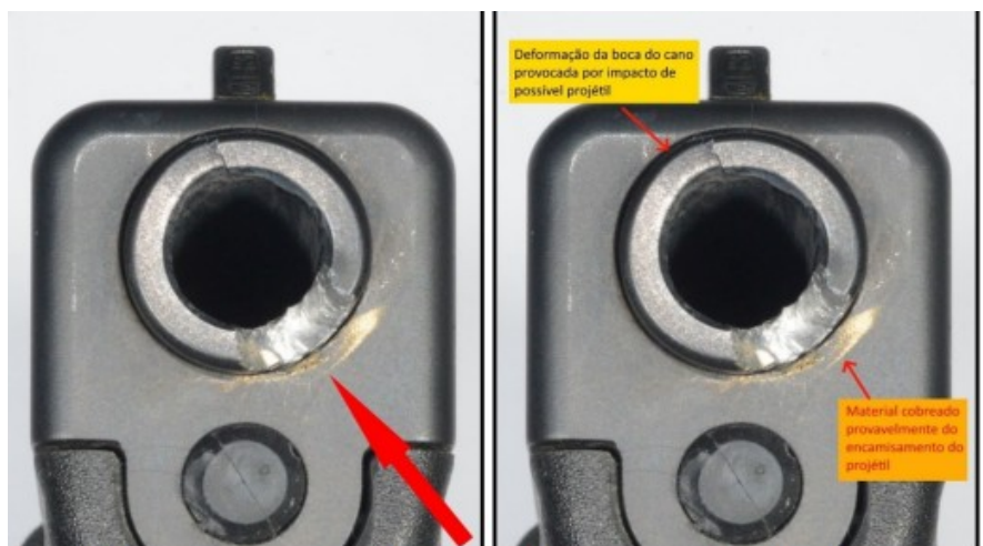
9 – AQ-03 vista pela parte frontal mostrando danos apresentados na boca do cano.
